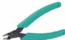
Pinzas de precisión para corte de alambre
